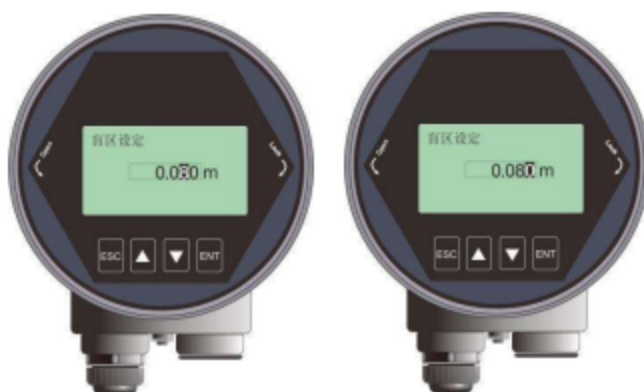
图 6-34 【DN】键实现光标右移
